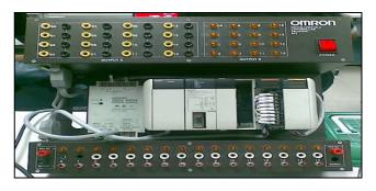
Fig. 6 PLC type OMRON CQM1H
