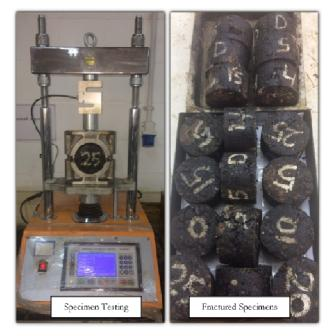
Fig. 4 Marshall Test
