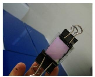
Fig. 7 Prototype of DSSC
