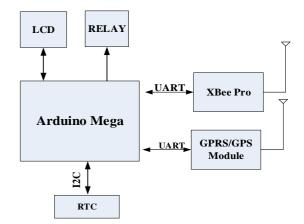
Fig. 6 Block diagram data logger module
