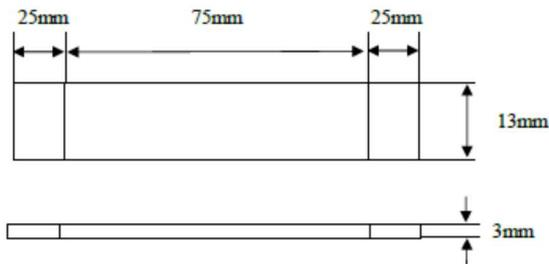
Fig. 9 ASTM D635-03
