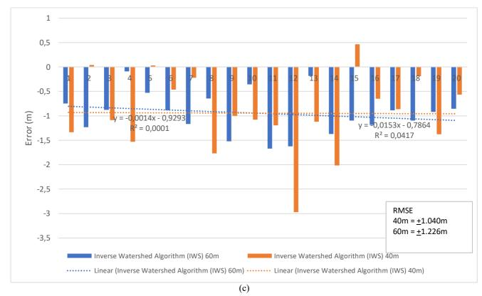
Fig. 4 Error pattern; a) WS algorithm, b) OBIA, c) IWS
