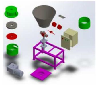
Fig. 4 Components of mini wood pellet machine
