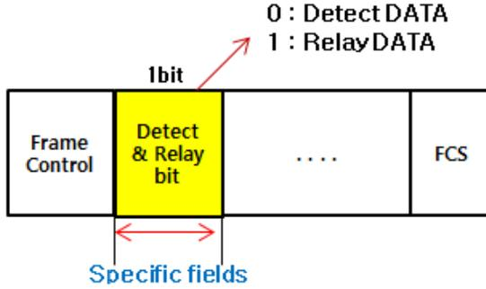
Fig. 2 Tx-beacon frame format
