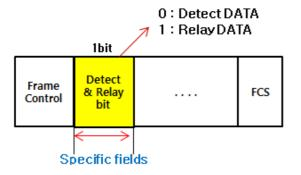
Fig. 2 Tx-beacon frame format
