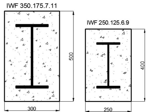
(d) Detail of structural elements (columns and beam)
