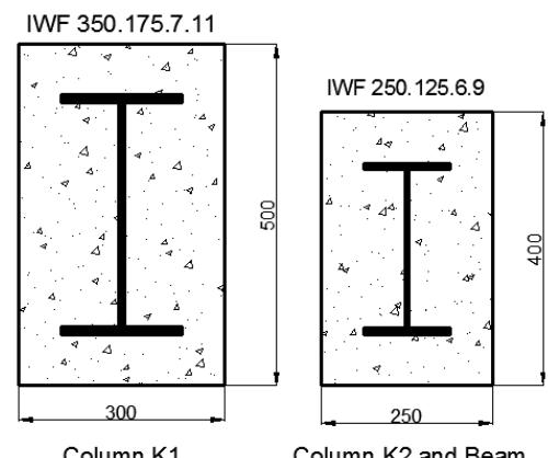
(d) Detail of structural elements (columns and beam)
